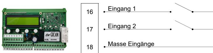
**Achtung:** Wenn die entsprechende Funktion an den Eingängen gewählt ist, hat die Sperrschwelle zwei Werte (A und B). Das Gerät verwendet die Schwellenwerte A oder B je nach Zustand der Eingänge.
